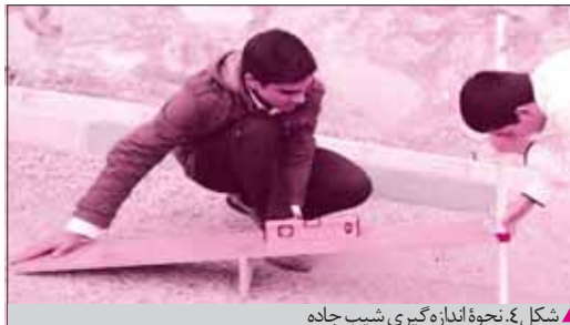
شکل ۴: نحوه اندازه‌گیری شیب جاده
